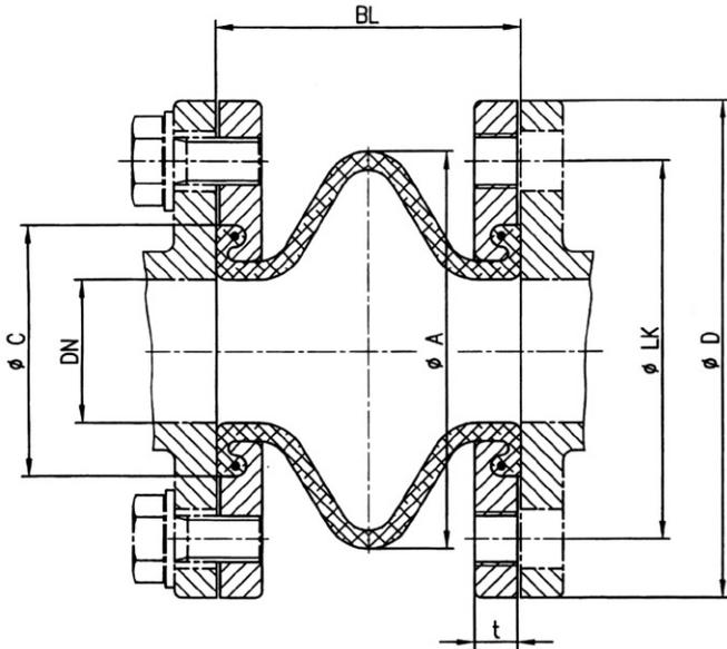
Der Balg legt sich je nach Druck an den Flansch. Deshalb können Schrauben mit Muttern nicht eingesetzt werden.
