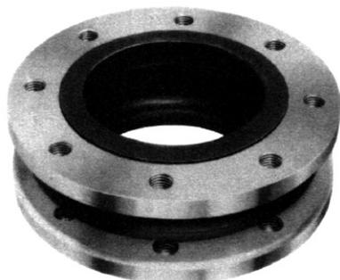
mit reißfesten Kunstfaser-Einlagen (Nylon-Cord) bzw. aus Nomex beim Typ „rot-spezial“ bis 16 bar Betriebsdruck – bei ca. 5-facher Sicherheit für Unterdruck bis 2 m WS ohne Stützring bzw. bis 9 m WS mit eingesetztem Stützring
