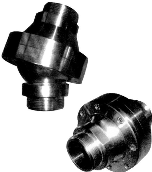
Kugel-Drehgelenke verhindern Torsion und das Abknicken von Schlauchleitungen. Der Schwenkwinkel von insgesamt ca. 50° vermeidet viele Schäden, die sonst durch enges Biegen von Schläuchen im Armaturenbereich entstehen.
